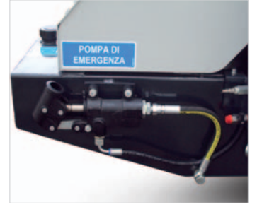
Erişim ve kullanım kolaylığına sahip acil durum el pompası
